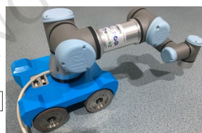
图 7 爬壁机器人+6 轴机械臂
