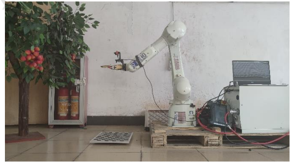
图 5 基于双目 eye in hand 系统的多角度树干位姿估计实验环境
