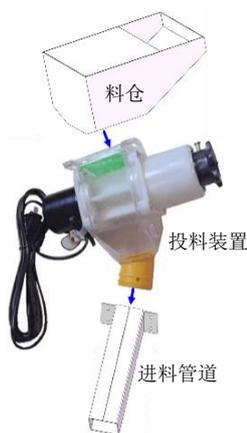
图 3 投喂装置结构图
