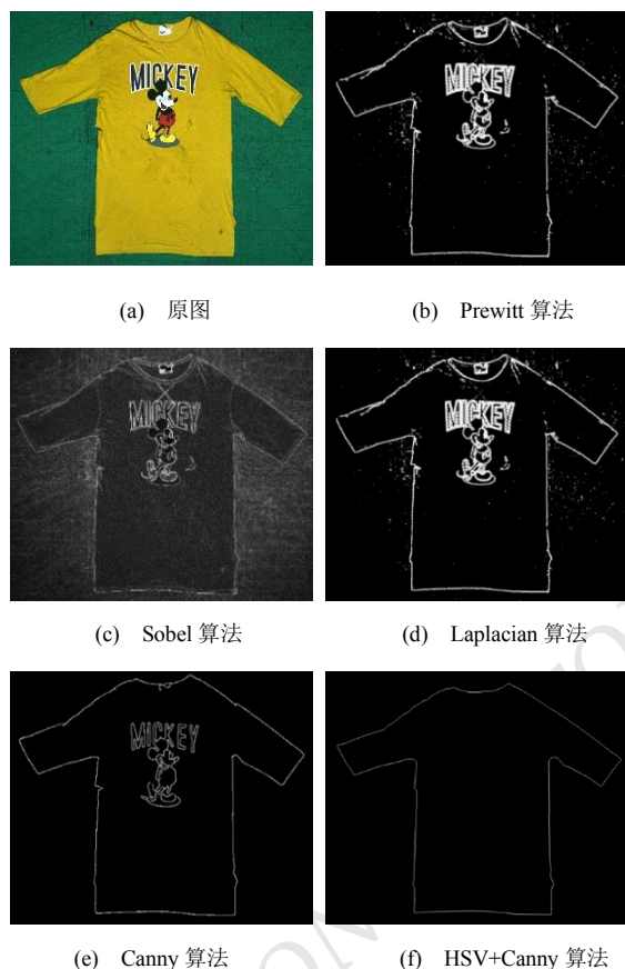
图 7 边缘检测效果仿真图
