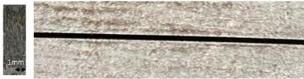
(a)  $z$  轴幅振 1 mm, 频率 2 kHz 时, 薄材激光切割效果
