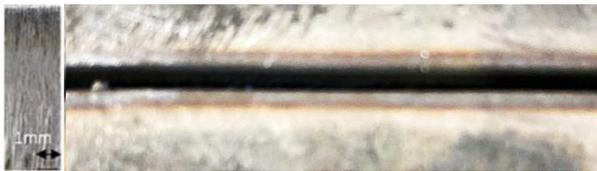
(b)  $z$  轴幅振 5 mm, 频率 4 kHz 时, 厚材激光切割效果
