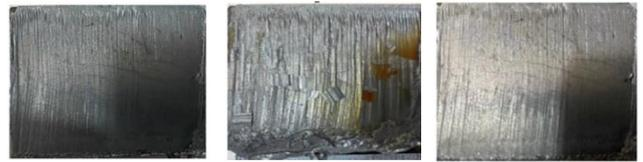
(a) 静态表面质量优先切割方法断面 (b) 静态最快切割方法断面 (c) 动态复合切割方法断面
