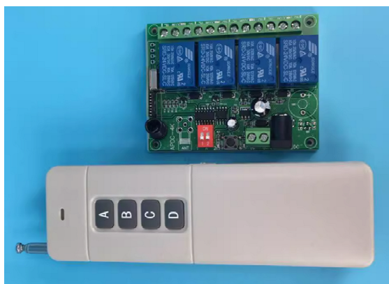
图 11 大功率无线遥控器 KGS-D24-4000 测试
