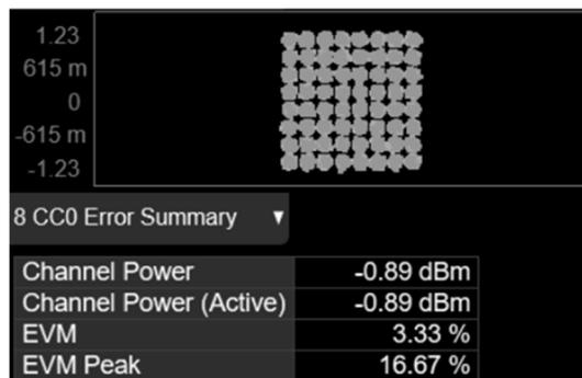
图9 验证平台信号 IQ 不平衡校准前解调图
